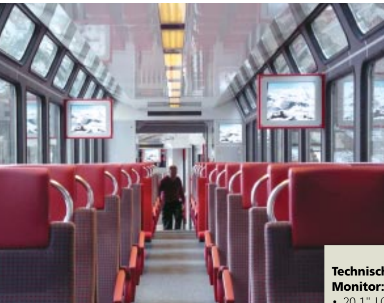
9 hochauflösende 20" LCD- Flachbildschirme sind in einem Fahrgastraum installiert
